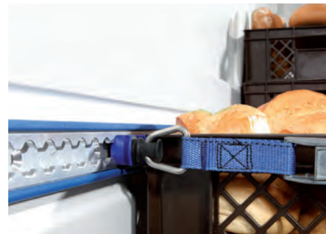
Systemschiene, Ladegutsicherung mit Spanngurten (Sonderausstattung)
